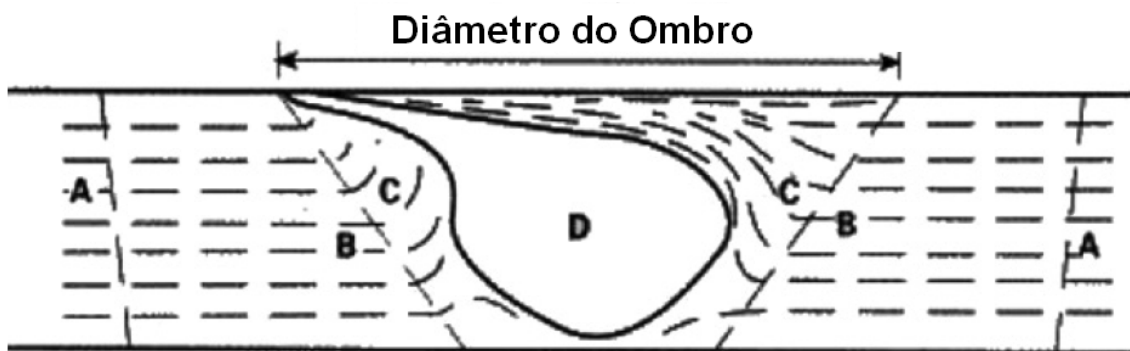
Figura 5: Esquema da seção transversal de uma típica união produzida pela soldagem por fricção linear, mostrando suas quatro zonas típicas: (a) metal-base; (b) zona afetada termicamente; (c) zona afetada termomecanicamente; (d) zona de agitação (botão de soldagem) [Nandan 2008].
