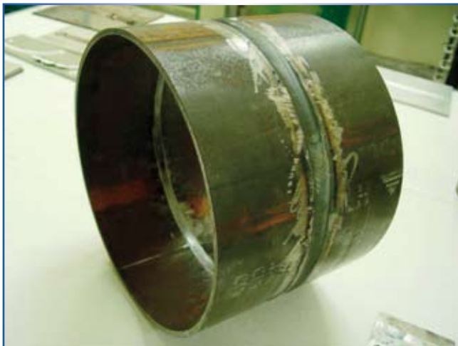
Fig. 7 – Aspecto final do cordão de solda circunferencial feito pelo processo de fricção linear em tubo grau API X65 (4)
