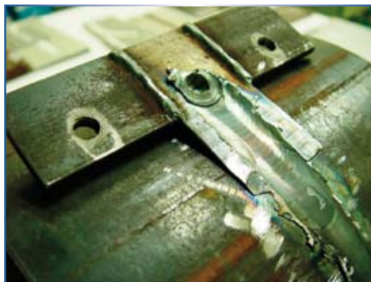
Fig. 3 – Lingueta para escape posicionada no final da soldagem circunferencial de um tubo (4)
