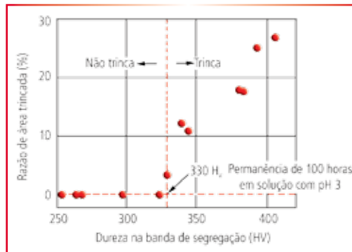
Fig. 7 – Relação entre dureza na banda de segregação central da chapa grossa e o trincamento decorrente da fragilização induzida por hidrogênio (7)
