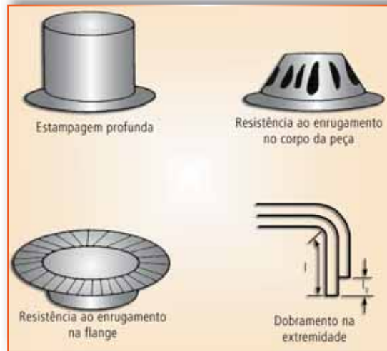
Fig. 6 – Ensaios de conformabilidade selecionados para estudar os níveis mínimos de resistência na interface metal-polímero necessários.
