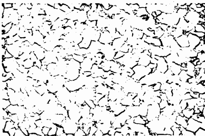
Figura 1: Microestrutura bifásica do aço ao Mn-Si-Cr-Mo laminado a quente, submetido à temperatura de acabamento de 950°C e resfriado ao ar. Ataque: Nital 5%. Aumento: 400 x.
