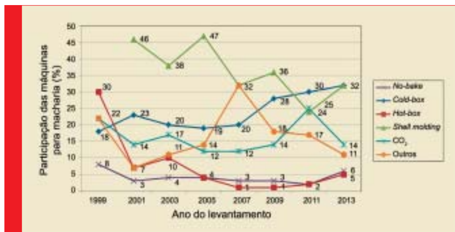
Fig. 14 - Distribuição percentual do número dos diversos tipos de máquinas de macharia utilizadas nas fundições participantes dos inventários da FS
