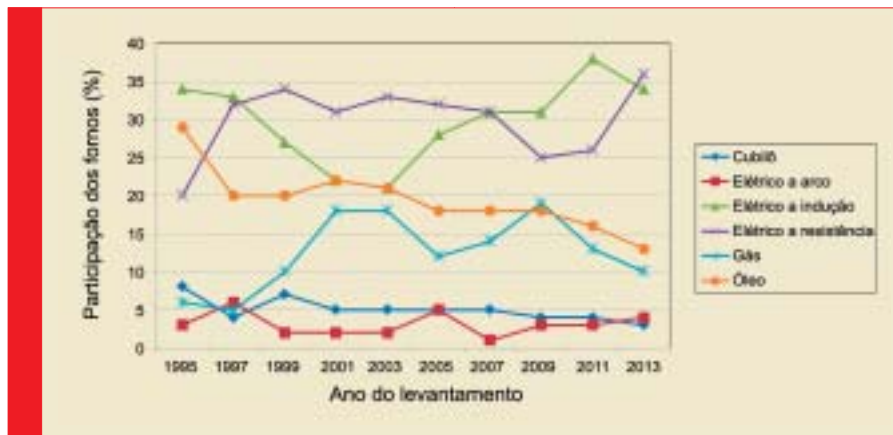
Fig. 3 – Distribuição percentual do número de unidades dos diversos tipos de fornos utilizados nas fundições pesquisadas pela FS
