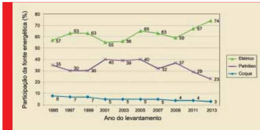
Fig. 4 – Distribuição percentual, em termos do número de unidades, das fontes energéticas dos fornos utilizados nas fundições participantes dos diversos inventários realizados pela FS
