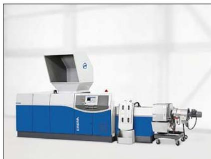
*Fig. 11 – Na COAX, desenvolvida pela Erema, um único motor aciona o moinho e a extrusora. A instalação das unidades permite a alimentação direta da extrusora, sem a necessidade da pré-trituração das peças e aparas*
