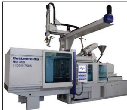
*Fig. 12 – A HM, exibida pela Battenfeld, integra as fases de montagem diretamente no processo de injeção. A máquina realiza a injeção de dois componentes, opera juntamente com um robô e possui módulo para a inserção de rótulo e injeção auxiliada por gás*
