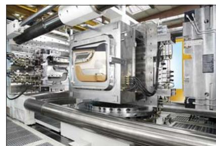
Fig. 15 – Detalhe da moldagem do revestimento interno de uma porta de automóvel e da sobremoldagem de uma pele de PU na mesma peça, feita na instalação montada pela Krauss Maffei
