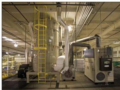
*Fig. 21 – EnergySmart Drying System, desenvolvido pela Conair, para a secagem do PET, que faz o reaproveitamento do ar quente usado no processo de secagem*
