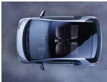
Fig. 24 – Teto transparente do automóvel *Smart for two*, feito com blenda PC/ABS e PC. Sua área é de 1,2 m<sup>2</sup>, a maior entre os tetos automotivos feitos com resinas plásticas.
