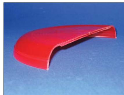
Fig. 14 – Peça oca produzida pelo processo GasCore
