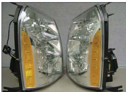
Fig. 29 – Os faróis dianteiros do modelo Cadillac Escalade, da General Motors, apresentam lentes de PC Makrolon, fabricado pela Bayer, em cor âmbar para os LEDs indicadores de movimento lateral, e moldura cromada, feita com a mesma resina
