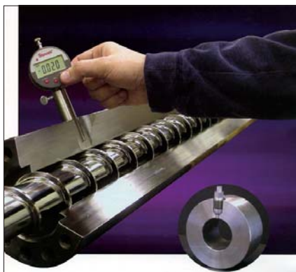
Fig. 21 – Sistema SmartBarrel, desenvolvido pela Glycon Corporation para facilitar a medição de desgaste do canhão e da rosca de extrusoras
