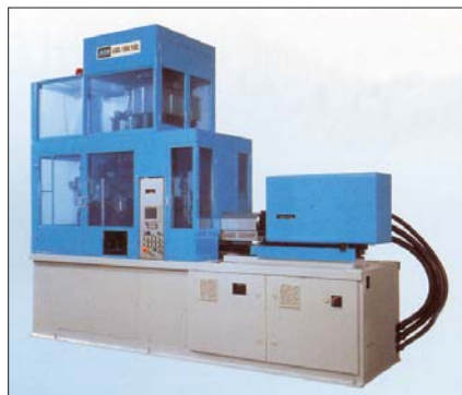
Fig. 14 – Máquina totalmente elétrica para injeção, estiramento e sopro de pré-formas de PET, lançada pela ASB
