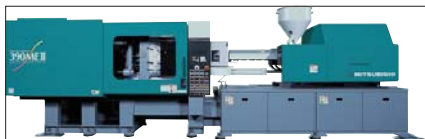
Fig. 6 – Os equipamentos da série MEII, fabricada pela Mitsubishi, possuem sistema de controle variável da temperatura do molde, o que evita a formação de linhas de solda em peças automotivas
