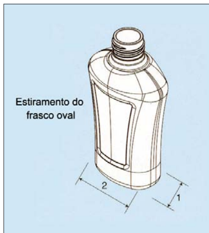
Fig. 13 – O aquecimento preferencial, recurso apresentado por muitos fabricantes de sopradoras, prepara as pré-formas para um estiramento com diferentes requisitos de temperatura em cada lado
