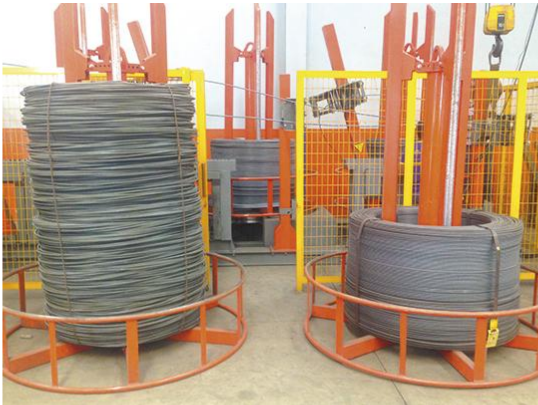
Figure 1: Rebar as “wild coil” in the left side and spooled rebar in the right side (Source: https://industrializaremconcreto.com.br/Edicoes/Exibir/mais-produtividade-em-processos-industrializados ).
